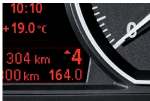
Schakelindicator (aanduiding ideale versnellingskeuze, alleen voor uitvoeringen met handgeschakelde 6-versnellingsbak). Adviseert u een hogere of lagere versnelling als deze een gunstiger brandstofverbruik mocht opleveren.
