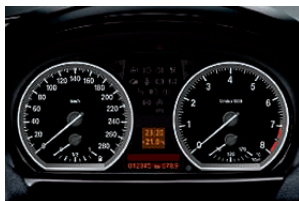
Het instrumentenpaneel van de BMW 130i is voorzien van een op de prestaties afgestemde calibrering. Daarnaast beschikt de 130i over een olietemperatuurmeter.
