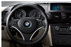
Met leder bekleed multifunctioneel sportstuur met geïntegreerde toetsen (diameter 369 mm), driespaaks. Met de toetsen kunnen tijdens het rijden bijvoorbeeld radio en telefoon (optie) worden bediend. Stuurwielverwarming voor met leder bekleed multifunctioneel sportstuur: verwarmt met een druk op de knop binnen korte tijd de stuurwielkrans; zeer aangenaam in de winter.
