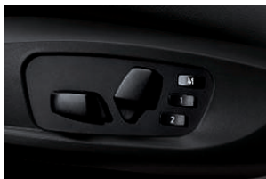
Zetelverstelling voor bestuurders- en voorpassagierszetel, met elektrische langs-, zithoogte-, zithoek- en rugleuningsverstelling. Inclusief memory-functie voor bestuurderszetel en buitenspiegels (incl. stoeprandfunctie voor de rechterbuitenspiegel). Twee individuele posities kunnen worden opgeslagen voor bestuurderszetel en buitenspiegelinstellingen.
