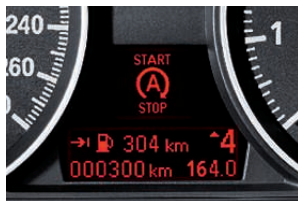
Auto Start Stop aanduiding. Toont in het info display wanneer de motor is afgezet door de Auto Start Stop functie, bijvoorbeeld voor een verkeerslicht of in een file. De aanduiding verdwijnt zodra de motor automatisch weer wordt gestart (voor alle viercilinder modellen; alleen i.c.m. handgeschakelde 6-versnellingsbak).
