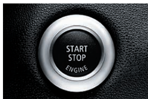
Start-/stopknop. Eerst wordt de afstandsbediening in de contactschakelaar geschoven. Daarna kunt u uw BMW met een druk op de knop starten of stoppen. Keyless go. Voor het ver-/ontgrendelen en starten van de auto zonder de afstandsbediening ter hand te hoeven nemen. Inclusief instapverlichting in de portiergrepen.
