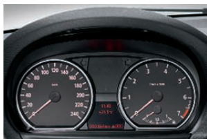
Instrumentenpaneel met analoge instrumenten en rode doorlichttechniek, snelheidsmeter, LC-display voor kilometer-/dagteller en boordcomputer, toerenteller met geïntegreerde tankinhoudsmeter (130i met motorolietemperatuurmeter, hier afgebeeld).
