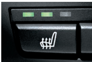
Zetelverwarming , drietraps, voor bestuurders- en voorpassagierszetel. Zitting en rugleuning, incl. zijwangen, zijn verwarmbaar en bieden in zeer korte tijd een aangenaam en warm zitoppervlak.
